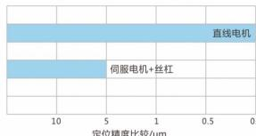
精度方面直线电机因传动机构简单减少了插补漂后的的问题，定位精度、重现精度、绝对精度，通过位置检测反馈控制都会较“旋转伺服机+滚珠丝杠”高，且容易实现。
