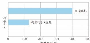
一般伺服旋转电机由于离心力的作用，高速运作时，将受到较大应力，因此转速和输出功率受到限制。相对而言，直线电机不受限制外，也没有机械损耗，从而提高传动速度。
